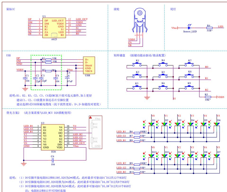
图 3. D26 搭配普通 RGB 灯应用电路图
